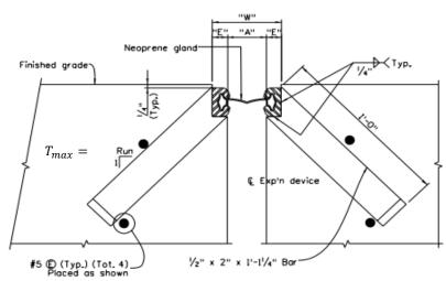
FIGURE 1 - BRIDGE EXPANSION DEVICE (0 - 4 INCH)
